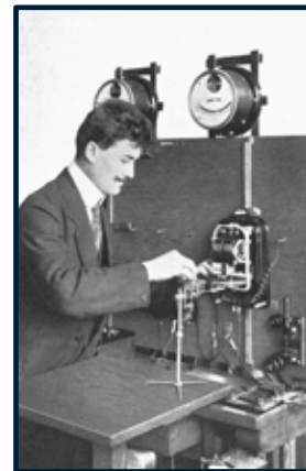
Drehmomentmessung am Zählerrotor [18]
